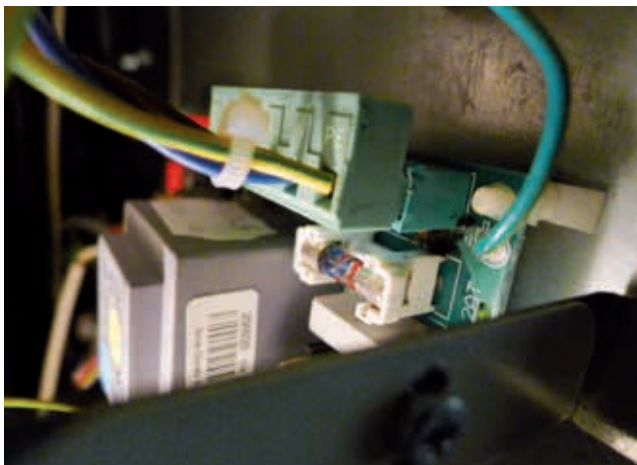
Kortsluiting op de printplaat bij de groene stroomdraad
