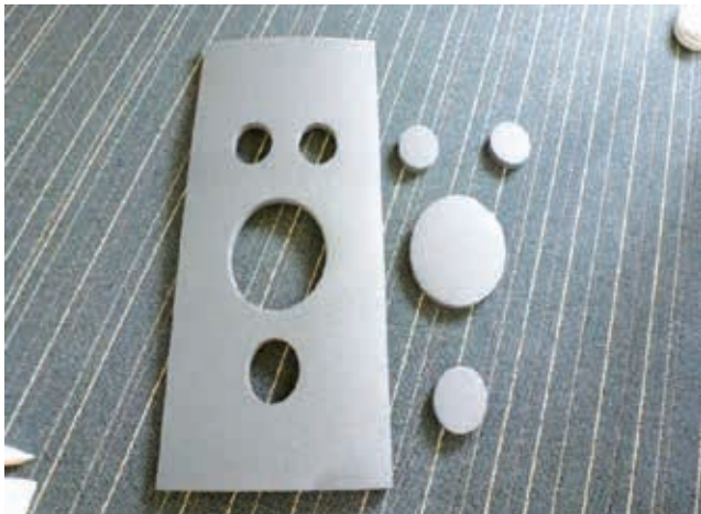
Correcte luchtdichte manchet van een 'flexibele' schuimplaat
