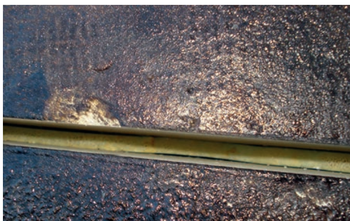
Verlies aan functionaliteit bij een 'beweegbare ondergrond' doordat hier geen gebruik is gemaakt van elastische purschuim.
